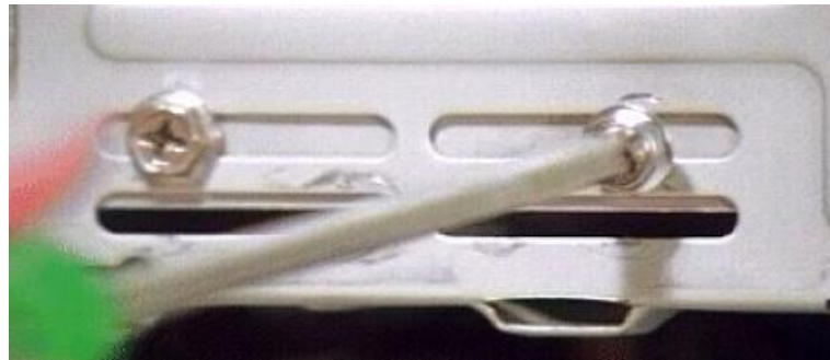
شكل رقم ١١٦: تثبيت محرك الأقراص الصلبة في الصندوق عن طريق مسمارين في كل جانب
