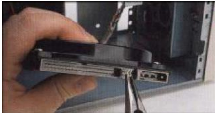
شكل رقم ١٢٠: ضبط محرك الأقراص الصلبة على أنه قرص سيد (Master)
