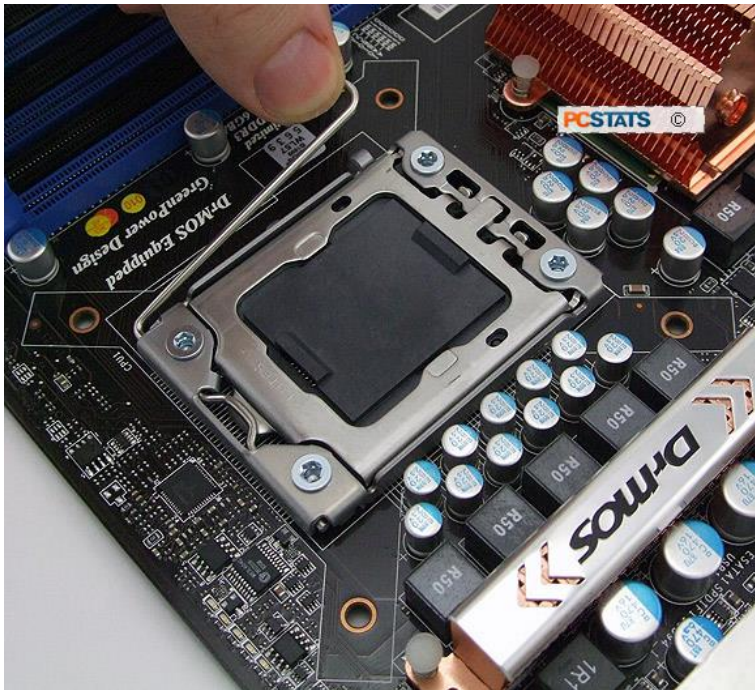
شكل رقم ٧٩: رفع الزراع المعدني لمثبت المعالج
