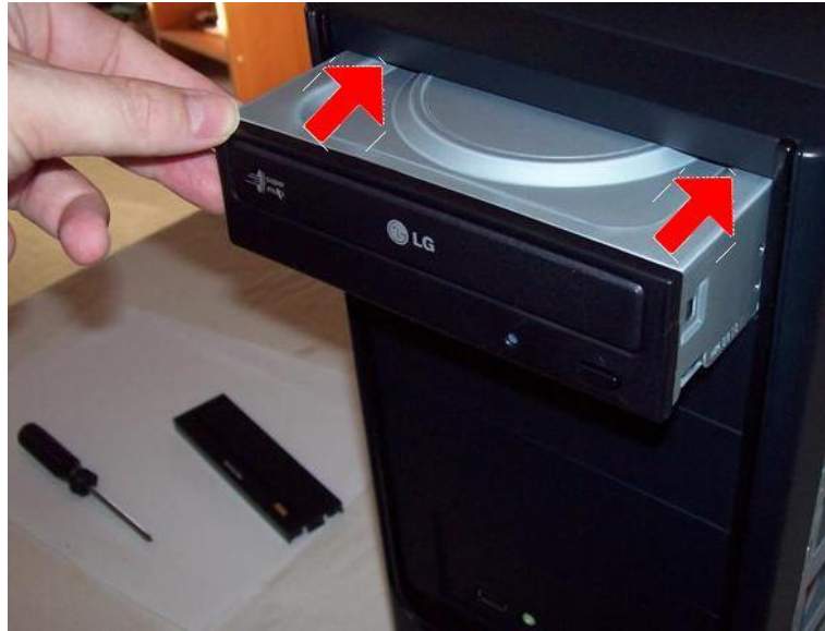
شكل رقم ١٠٧: إدخال محركات الأقراص الضوئية أو الليزرية أو المدمجة في الفتحة المخصصة لها
