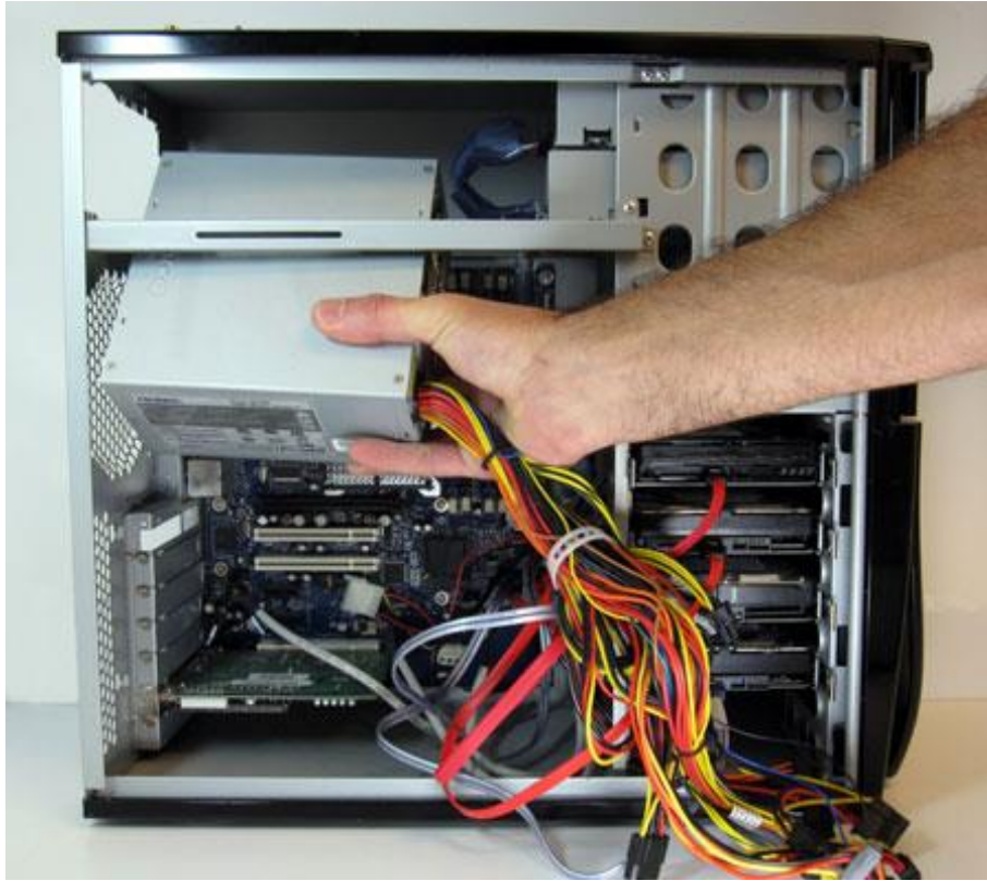
شكل رقم ٦٣: إدخال مصدر التغذية (Power Supply) في الصندوق (Case)
