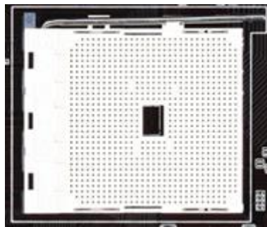
شكل رقم ٧٠: اشكال المنافذ التي تثبت فيها المعالجات في اللوحة الأم (Socket AMD AM3)
