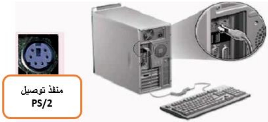
شكل رقم ١٧٢: توصيل لوحة المفاتيح (PS/2)
