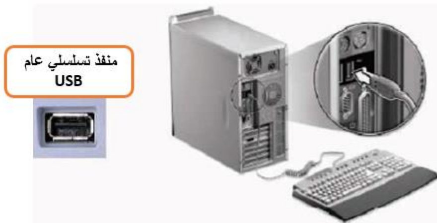
شكل رقم ١٧٣: توصيل لوحة مفاتيح (USB)
