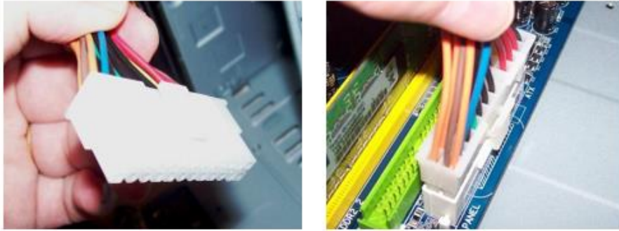
شكل رقم ١٥١: توصيل موصل ATX على المكان المخصص له في اللوحة الأم
