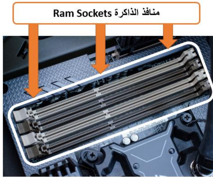
شكل رقم ٩٥: مكان تثبيت الذاكرة العشوائية في اللوحة الأم محدد باللون الأصفر
