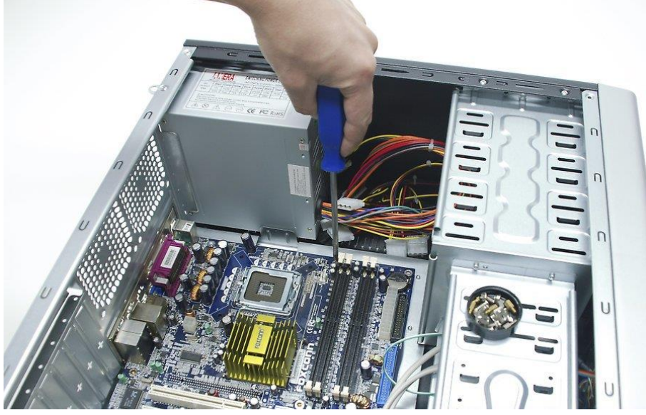
شكل رقم ١٠٣: تثبيت اللوحة الأم
