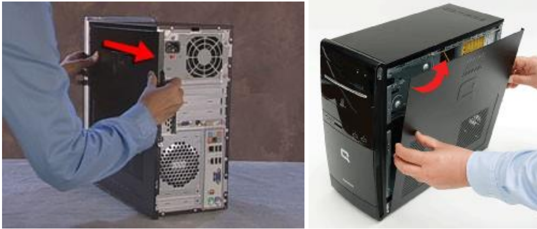
شكل رقم ٦١: احدى طرق فتح الصندوق Case
