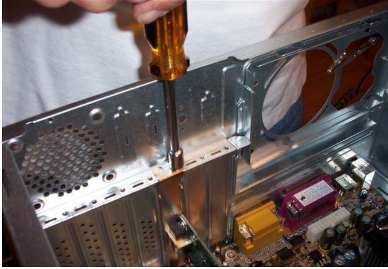
شكل رقم ١٤٠: تثبيت كارت الشبكة
