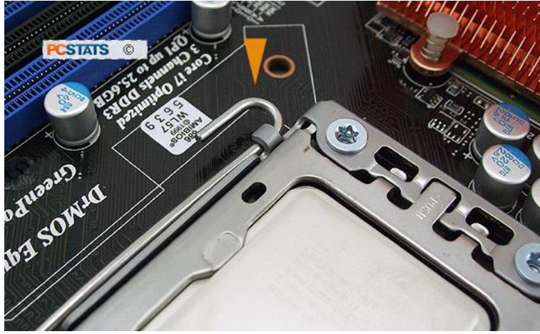
شكل رقم ٨٦: تثبيت المعالج الدقيق
