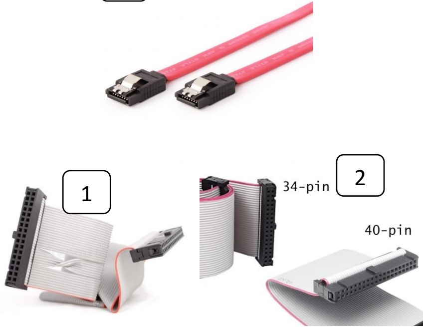
شكل رقم ١٤٧: شكل يوضح الأنواع الثلاثة لكابلات البيانات: (١) كابل بيانات محرك الأقراص المرنة (٢) كابل بيانات PATA لمحرك الأقراص الصلبة أو الضوئية من النوع IDE (٣) كابل بيانات SATA لمحرك الأقراص الصلبة أو الضوئية من النوع SATA
