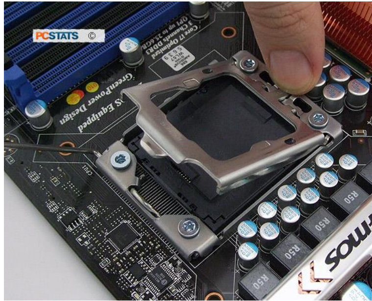
شكل رقم ٨١: رفع الغطاء المعدني
