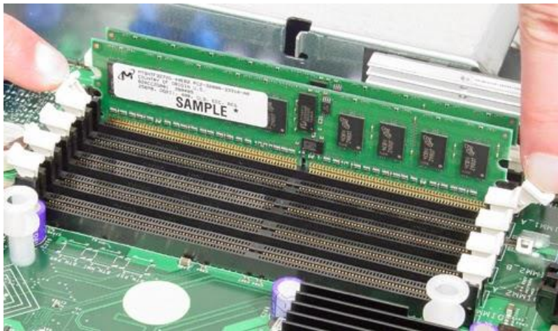
شكل رقم ٧١: شق تركيب الذاكرة العشوائية (Slot)
