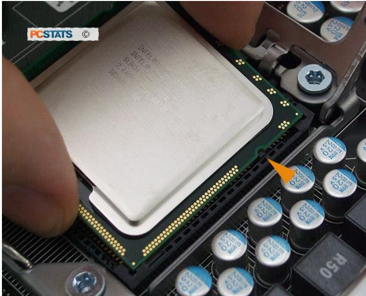
شكل رقم ٨٣: محاذاة المعالج الدقيق (Notch)
