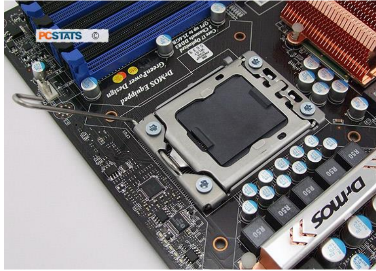
شكل رقم ٨٠: رفع الزراع المعدني لمثبت المعالج حتى النهاية المسموحة له
