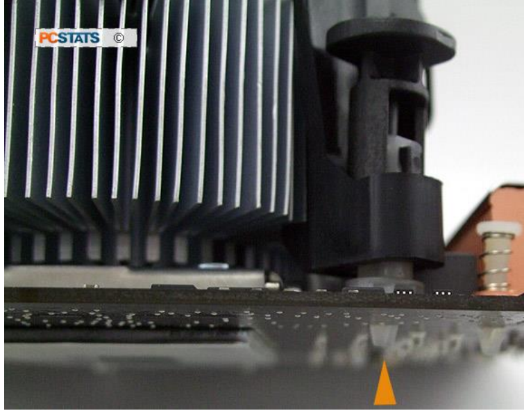
شكل رقم ٩١: تثبيت المروحة والمشتت الحراري
