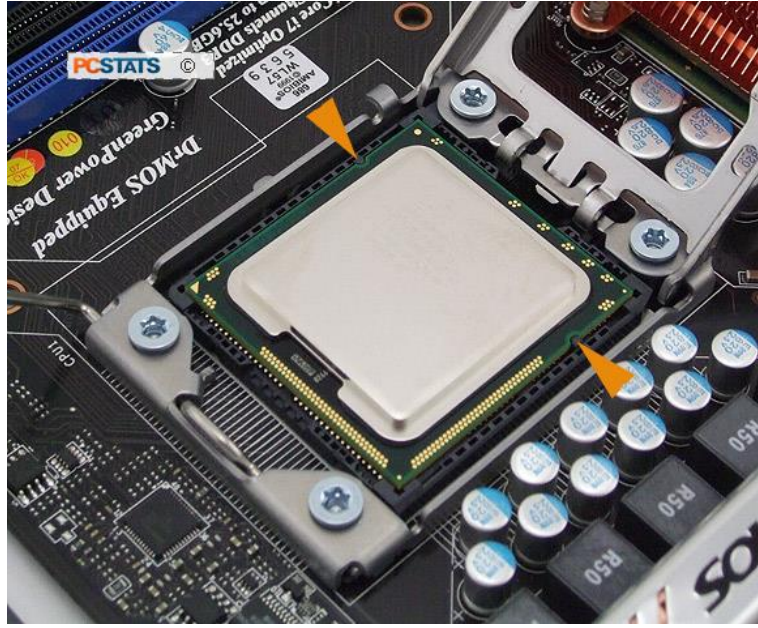
شكل رقم ٨٤: محاذاة المعالج الدقيق (Notch)
