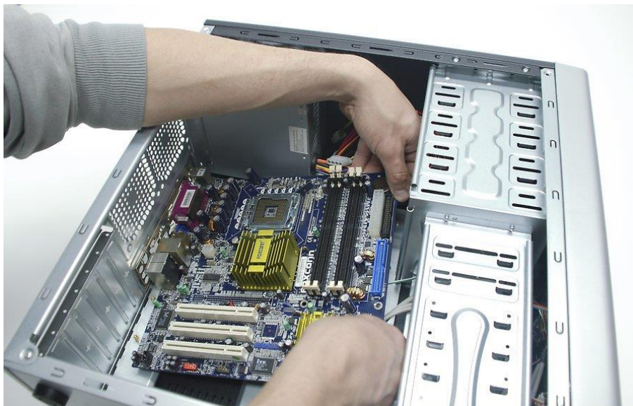
شكل رقم ١٠٢: تثبيت اللوحة الأم بالمسامير المخصصة
